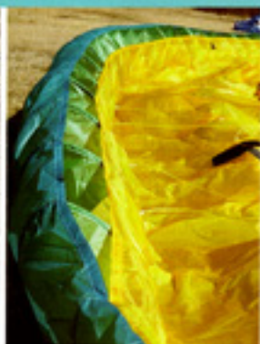
FLEXONにより、エアインテークが起き上がっている。
