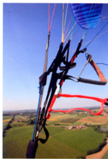
L'élévateur de la Force en vol. Il faut veiller à bien remettre en place la commande du stabilo sur son aimant, cette commande finissant par s'entortiller.
