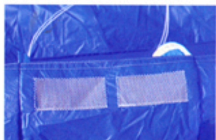
Le Hit Valve optimise la pression interne lors de la diminution de l'incidence.
