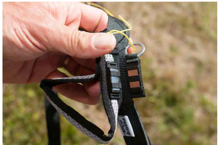
Metallrollen, kräftige Trimmer, übersichtliche Tragegurte, und Magnethalter für die Bremsschlaufen, die von selbst "richtig" herum in die Halterung springen.
