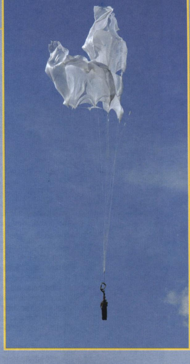
l'avantage de correspondre correctement à la norme EN 12491. Celle-ci précise en effet qu'après le choc le secours doit être stable. Or, il n'est guère possible de vérifier cet élément-là proprement, par exemple sur un camion, à cause des turbulences.
