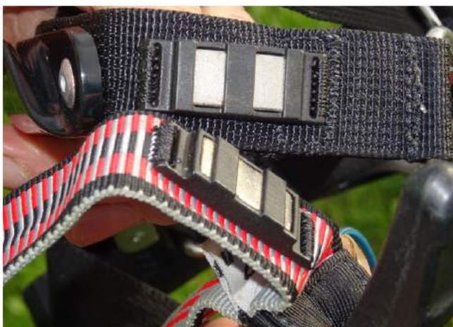
Astucieux: la forme de ses aimants cmet les poignées automatiquement parallèles à l'élévateur, quelque soit l'angle sous lequel on les présente.
