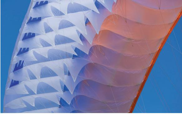
Sous cet angle, la différence entre les parties avant (caissons à droite) et arrière de l'aile (mono-surface à gauche) sont bien visibles.
