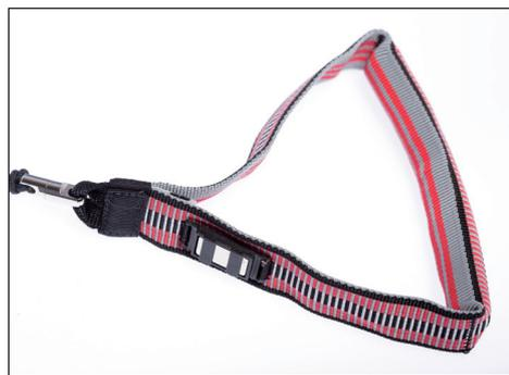
**L'aimant pour maintenir la poignée de frein sur l'élévateur est puissant.** Un tube souple apporte un peu de rigidité à la poignée.
