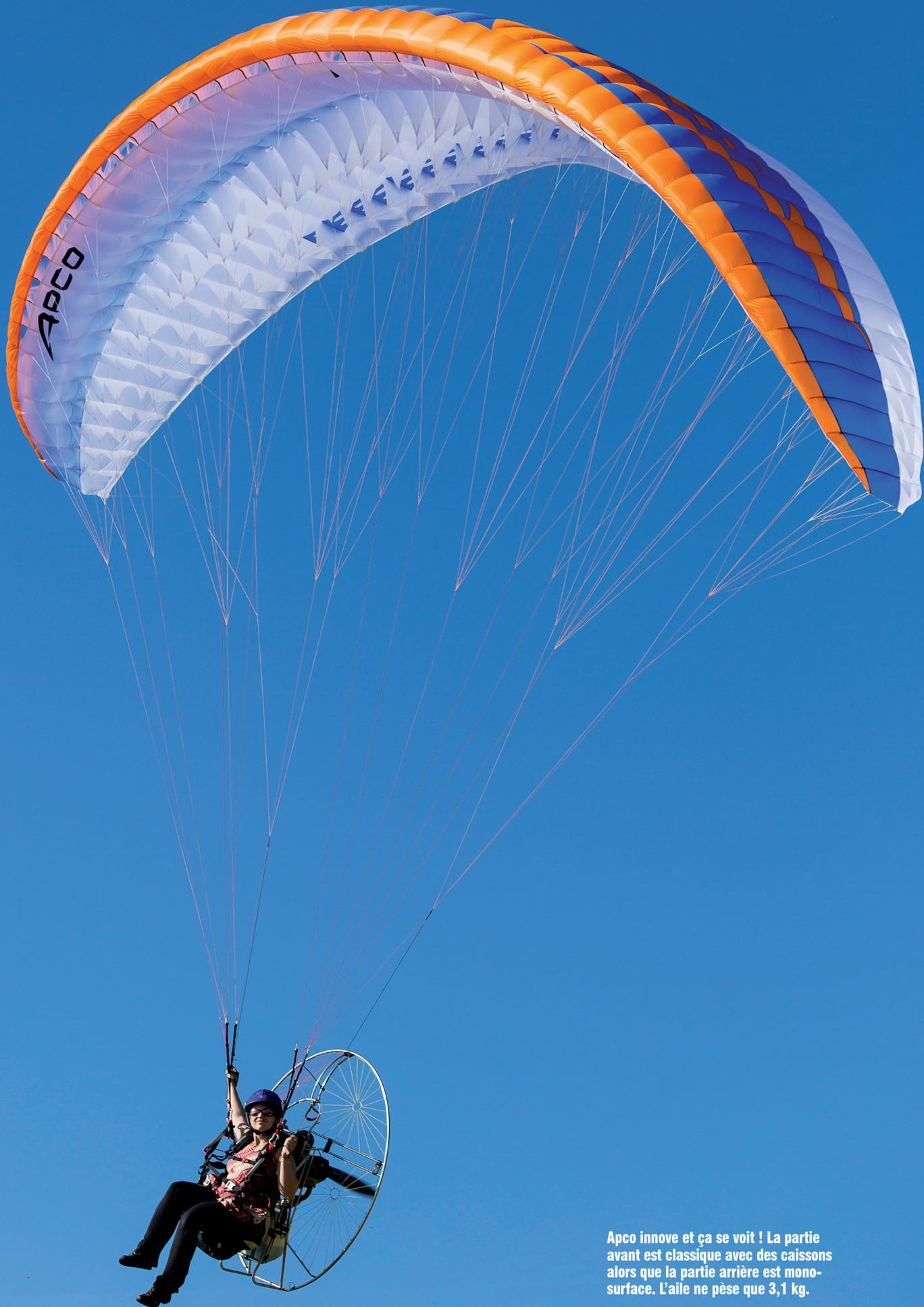
**Apco innove et ça se voit ! La partie avant est classique avec des caissons alors que la partie arrière est monosurface. L'aile ne pèse que 3,1 kg.**
