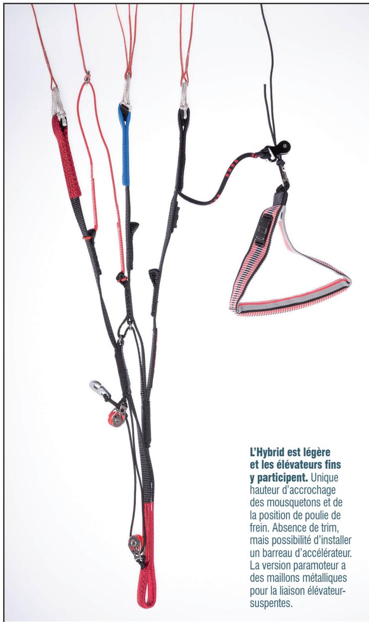
**L'Hybrid est légère et les élévateurs fins y participent.** Unique hauteur d'accrochage des mousquetons et de la position de poulie de frein. Absence de trim, mais possibilité d'installer un barreau d'accélérateur. La version paramoteur a des maillons métalliques pour la liaison élévateur-suspentes.
