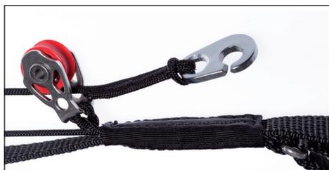
**Les élévateurs ne sont pas équipés de trim.** Pour accélérer l'Hybrid, il faudra impérativement connecter un barreau. Le gain de vitesse est alors de 7-8 km/h.
