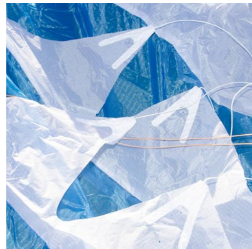
Zahlreiche Anlenkungspunkte im Einfachsegelbereich.
