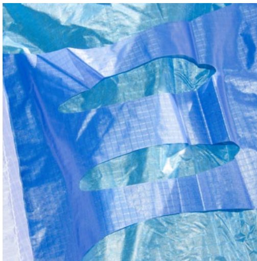
Verstärkungsbänder im hinteren Bereich. Übrigens sind auch im Achterliek Kunststoffdrähte.
