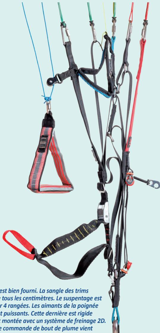
*L'élévateur est bien fourni. La sangle des trims est graduée tous les centimètres. Le suspentage est distribué sur 4 rangées. Les aimants de la poignée de frein sont puissants. Cette dernière est rigide à sa base et montée avec un système de freinage 2D. De plus, une commande de bout de plume vient en complément.*
