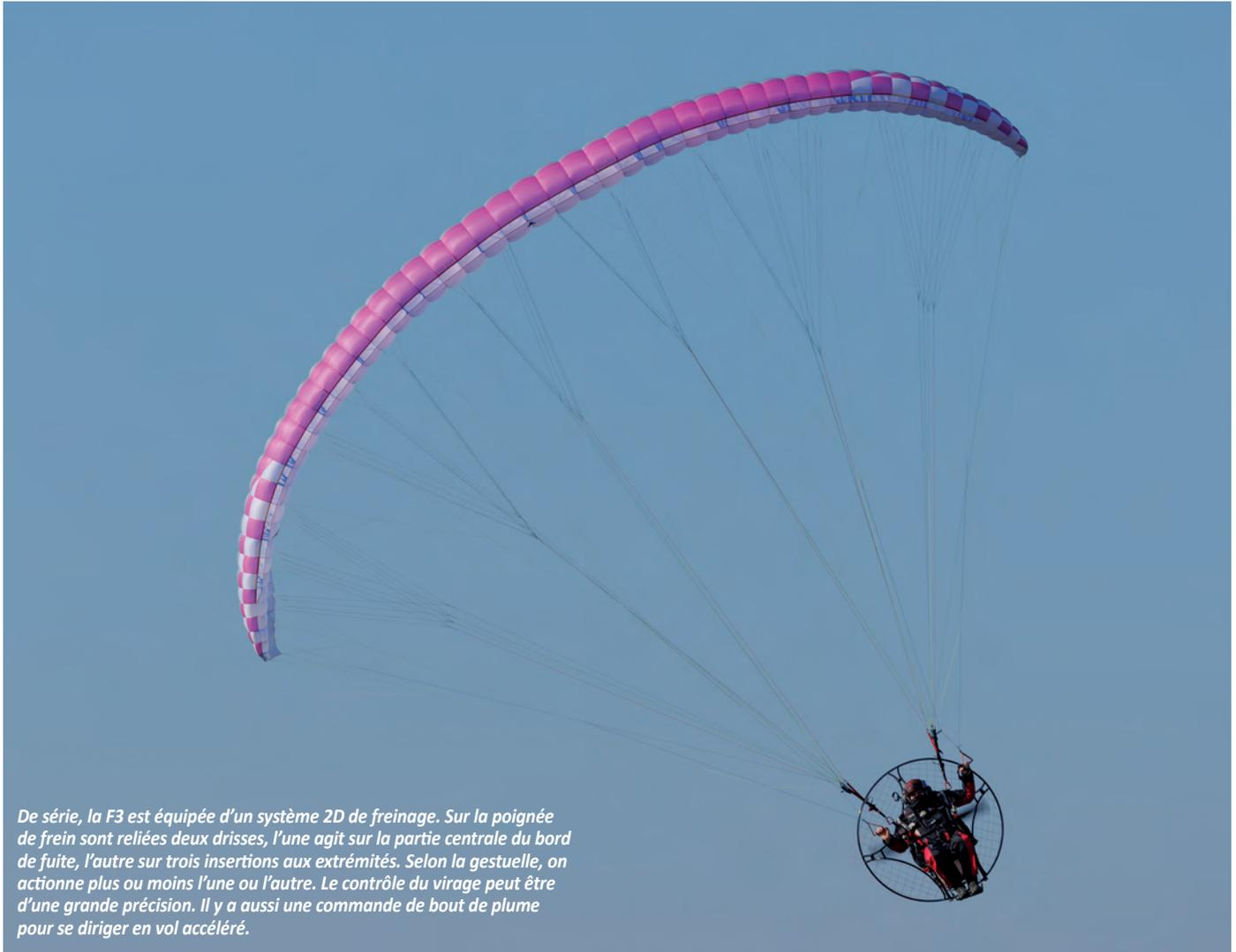
*De série, la F3 est équipée d'un système 2D de freinage. Sur la poignée de frein sont reliées deux drisses, l'une agit sur la partie centrale du bord de fuite, l'autre sur trois insertions aux extrémités. Selon la gestuelle, on actionne plus ou moins l'une ou l'autre. Le contrôle du virage peut être d'une grande précision. Il y a aussi une commande de bout de plume pour se diriger en vol accéléré.*
