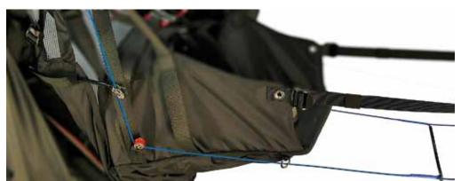
Originalité efficace de la série des Swift (déjà appréciée dans l'essai de la version Race), la position de la poulie lombaire d'accélérateur - en haut - est ajustable d'avant en arrière. Le réglage se fait au sol afin d'assurer à la fois fluidité de fonctionnement et surtout, garder une assiette constante en éliminant les effets « de bascule », à l'appui ou au relâché.
